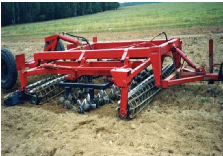
Pərli yumşaldıcı və vərdənə ilə kombinə edilmiş kultivator
